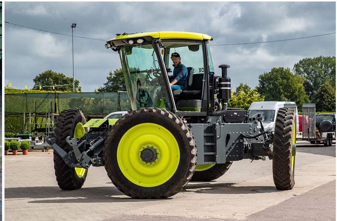
H2Trac waterstof-brandstofcel trekker aan Stadsboerderij Almere (31-5-2021)
